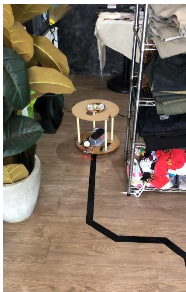
ภาพ 4.41 ภาพแสดงการหยุดของรถเซ็นเซอร์อาหารอัตโนมัติ เมื่อรถถึงจุดหมายแล้ว
