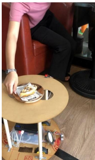
ภาพ 4.37 ภาพแสดงการหยุดของรถเซ็นเซอร์อาหารอัตโนมัติ เมื่อรถถึงจุดหมายแล้ว
