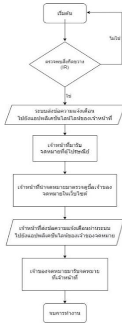
ภาพ 8 แผนผังการทำงานของระบบแจ้งการรับจดหมายและส่งข้อความแจ้งเตือนไปยังแอปพลิเคชันไลน์เจ้าของจดหมาย
