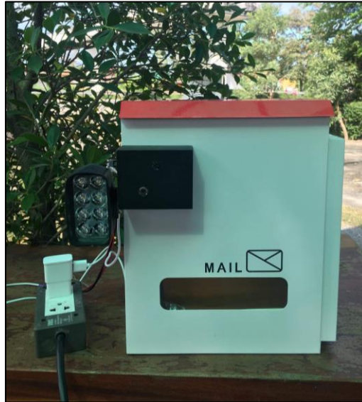
ภาพที่ 36 ตู้ไปรษณีย์ที่ติดตั้งอุปกรณ์ IoT
