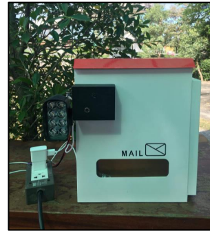
ภาพ 16 ตู้ไปรษณีย์ที่ติดตั้งอุปกรณ์ IoT
