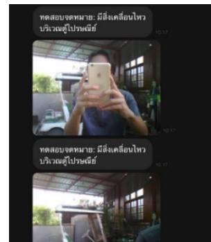
ภาพ 17 ภาพถ่ายที่ระบบตรวจจับการเคลื่อนไหวหน้าตู้ไปรษณีย์ส่งไปยังแอปพลิเคชันไลน์
