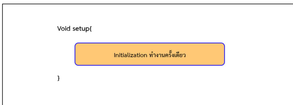
ภาพที่ 2.12 โครงสร้างภาคบังคับของ Arduino
