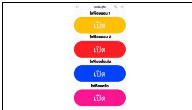
ภาพที่ ก.28 แสดงหน้าจอการควบคุมเปิด/ปิดไฟจากแอปพลิเคชัน Blynk IoT
