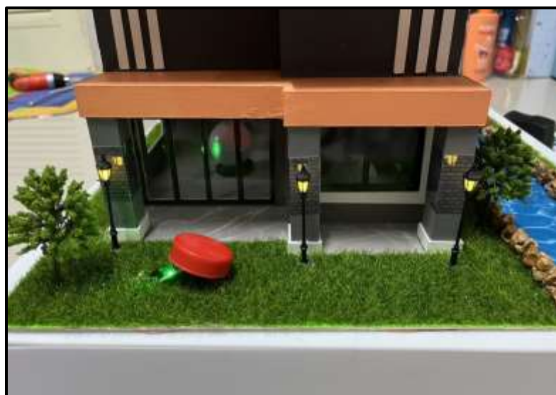
ภาพที่ 4.5 ระบบไฟหน้าบ้านเมื่อมีแสงน้อยไฟจะติดอัตโนมัติ
