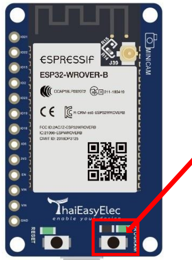
ภาพที่ ข.4 แสดงปุ่ม Button Program ของบอร์ด
