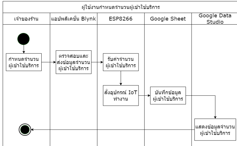
ภาพที่ 3.7 Activity Diagram ผู้ใช้งานกำหนดจำนวนผู้เข้าใช้บริการ
