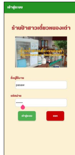
ภาพ 5 แสดงการเข้าสู่ระบบแอปพลิเคชันร้านป่าสาวเดี่ยวหนองเต่า จากภาพที่ 5 แสดงหน้าจอเข้าสู่ระบบ โดยเป็นหน้าแรกของแอปพลิเคชัน มีการทำงานของแอปพลิเคชัน คือ ผู้ประกอบการหรือพนักงาน จะทำการกรอกชื่อผู้ใช้งานและกรอกรหัสผ่าน เพื่อเข้าสู่ระบบ หากกรอกข้อมูลผิดระบบจะแจ้งเตือนให้ทำการกรอกใหม่อีกครั้ง และหากกรอกข้อมูลถูกต้องระบบจะแสดงผลหน้าจอหลัก
