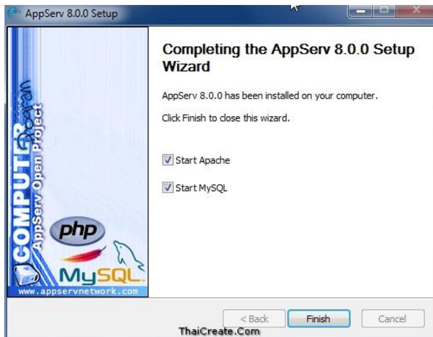
ภาพที่ 4.9 เสร็จขั้นตอนการติดตั้ง เลือก Start Apache และ Start MySQL เลือก Finish
